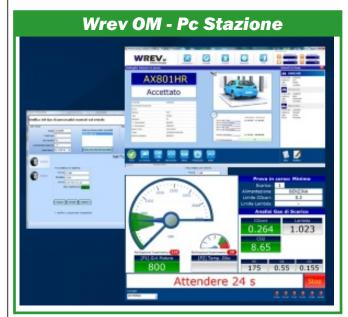
Wrev SP Omologazione 329/PCS/RSW/NET2/12/ RM Software applicativo per il controllo e la gestione delle misure, seguendo l'iter della revisione durante le prove.
